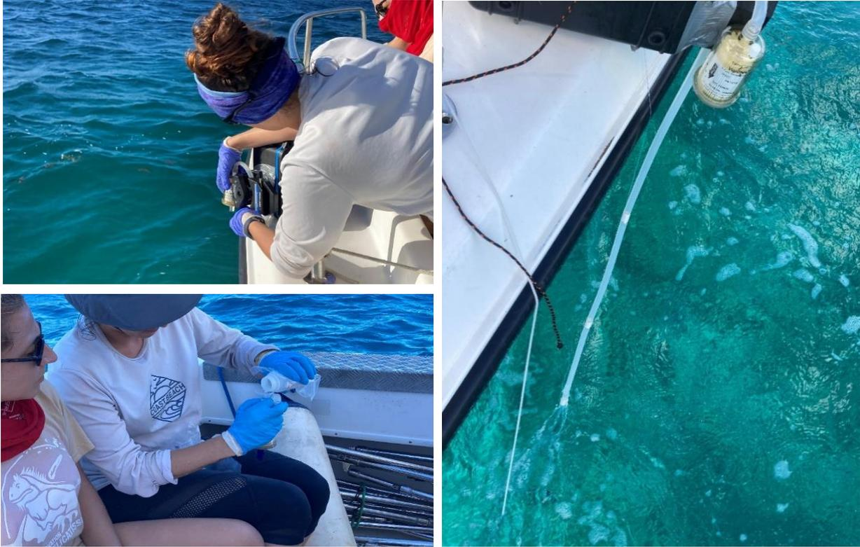
*Figure 2 : Installation de la capsule de filtration, filtration et préparation de l'échantillon pour stockage.*
